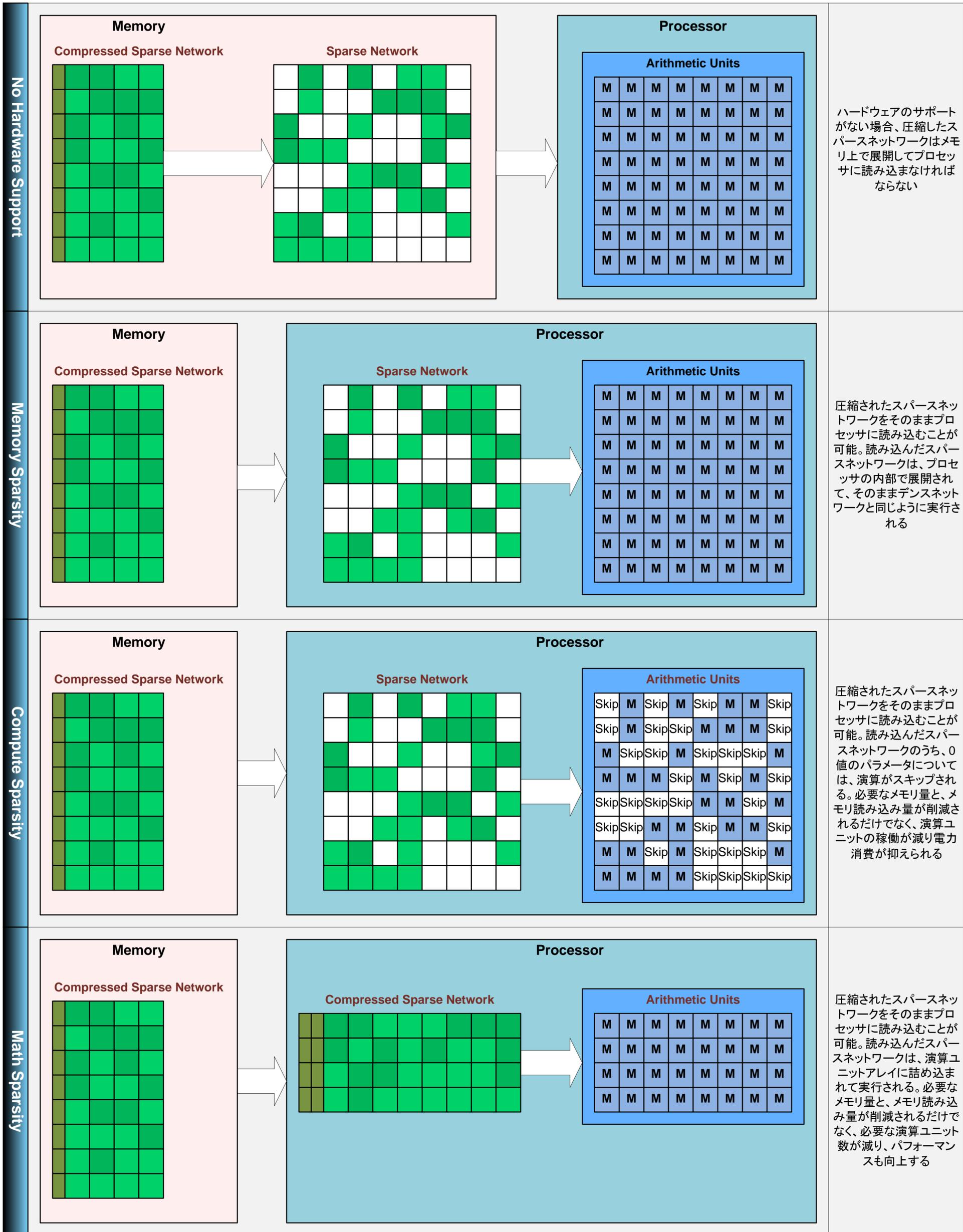
ハードウェアのサポートがない場合、圧縮したスパースネットワークはメモリ上で展開してプロセッサに読み込まなければならぬ
